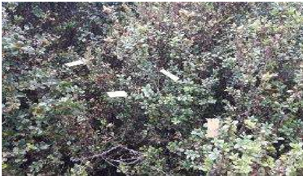
شکل ۳- نصب کارت‌های حساس به آب برای بررسی کیفیت محلول پاشی سمپاش‌ها
